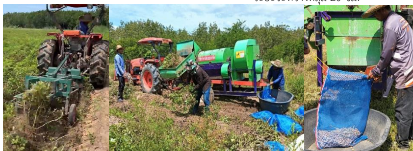
เครื่องชุดและเครื่องปลิดฝักถั่วลิสงจากลำต้นตัดท้ายรถแทรกเตอร์ของบริษัทแม่รวยการเกษตร
